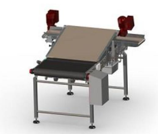
Über ein Teigrückführsystem wird der Restteig, der bei der Produktion von runden und ovalen Pizzaböden entsteht, sauber und kontrolliert abgezogen und mittels eines Transportbandes zur Wiederverarbeitung zurückgeführt.
