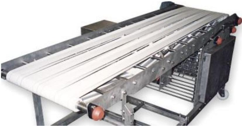
Unsortierte ankommende Brote z.B. aus einer Spirale werden mit dem Vibrationsband ausgerichtet und in einzelne Spuren sortiert.
