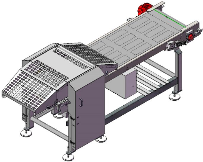
Der Mitfahrslitten des Querschneiders synchronisiert sich auf dem darunter befindlichen Produktionsstrang.
